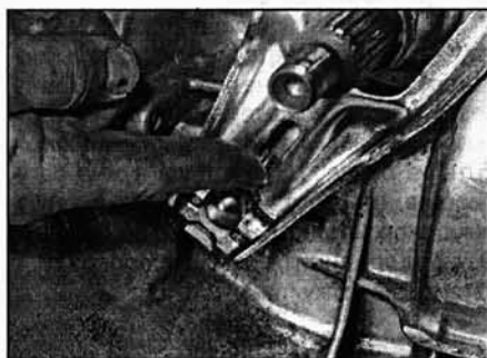
Рис. 7.2,а. На коробках передач 012 отсоедините рычаг выключения сцепления от шаровой шпильки
